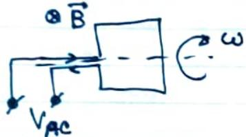
$$V_{AC} = V_{max} \cos \omega t$$
