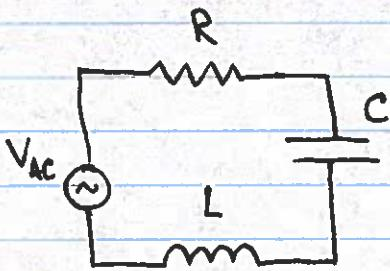
$$V_{AC} - IR - \frac{Q}{C} - L \frac{dI}{dt} = 0$$
